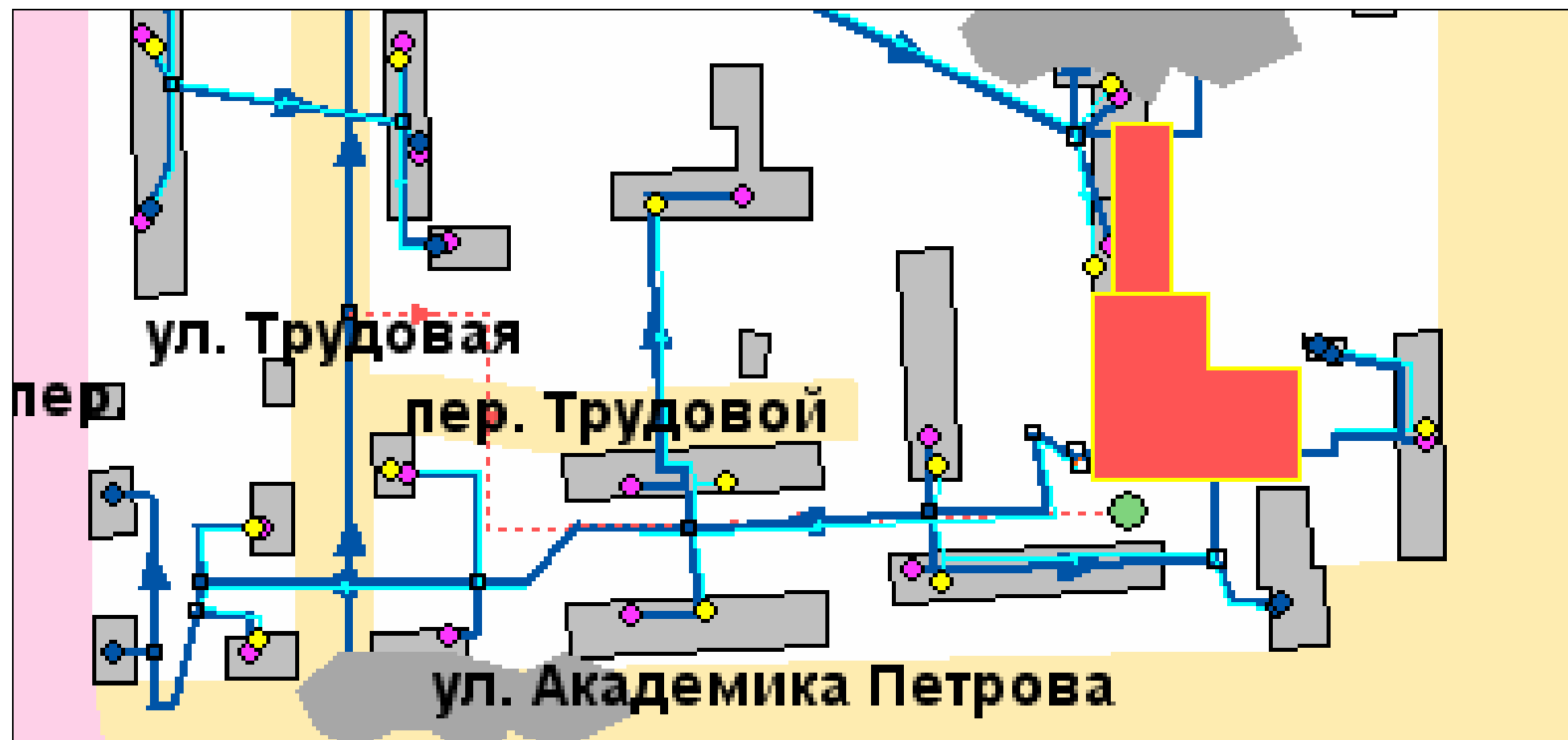
Рисунок Е 3 – Схема тепловых сетей котельной № 4
