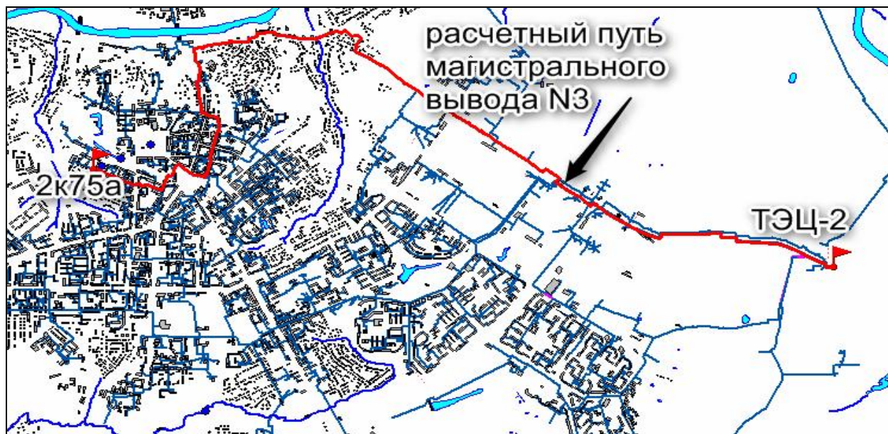
Рисунок Д.6 - Трассировка расчётного пути от ТЭЦ-2 до конечных потребителей магистрали N3 – РС 2к-2к75а.
